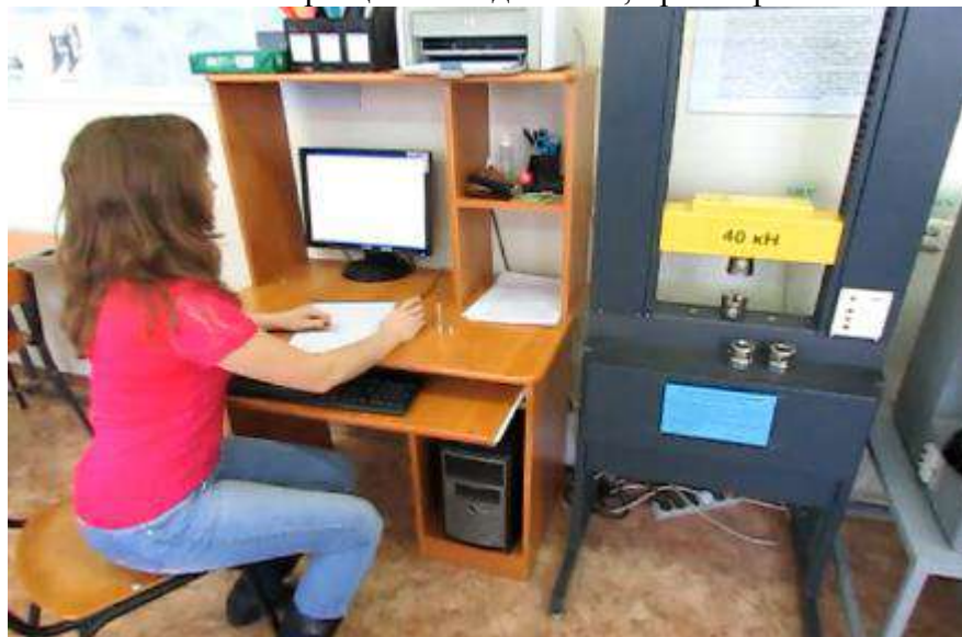
Рис. 1 - Испытание на прочность с помощью растяжной машины МИУ-40У
